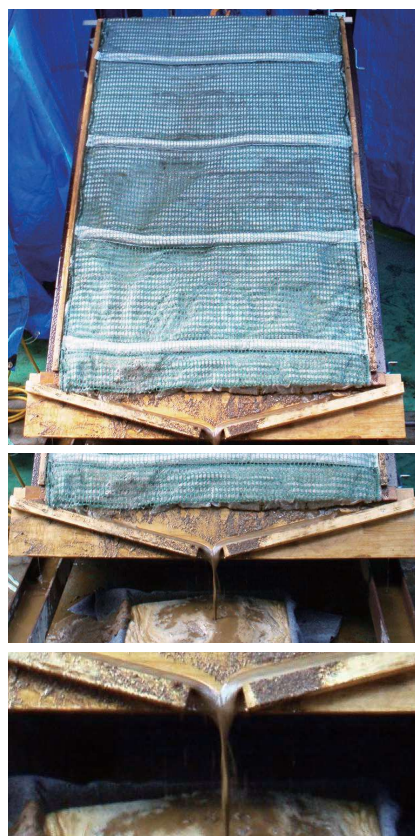
植生マット(肥料袋付) 試験雨量 100mm/h
