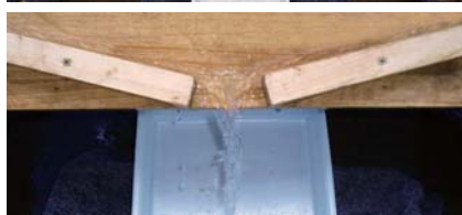
ソイルテクター S 試験雨量 400mm/h
