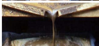
植生マット(肥料袋付) 試験雨量 100mm/h
