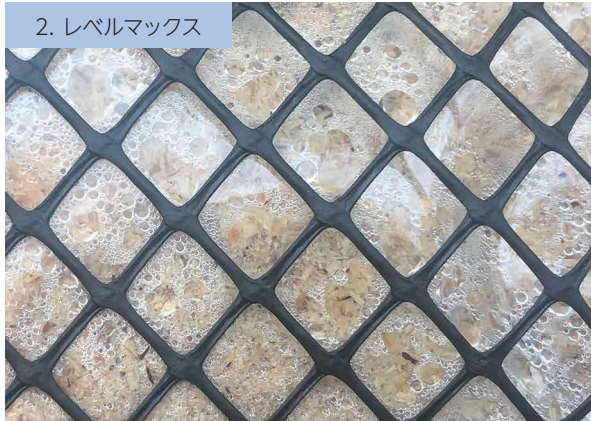
流速軽減袋内部の蒸発抑制状況
