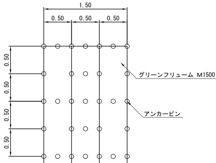
注2) : 植生マットの上下接続部は、上側のマットの下に、下側のマットがくるよう重ね合わせを行って下さい。
