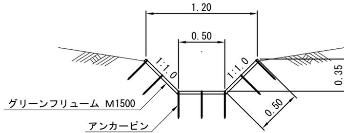
注1) : 上記断面形状は一例であり、幅1.5mのマットを使用し、仕上げることでできる断面であれば、幅や深さを変更することが可能です。
