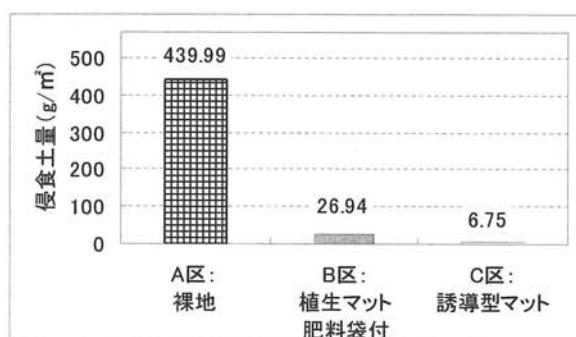
図2. 侵食試験結果① (A区, B区, C区)
