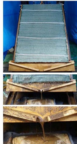
植生マット工(肥料袋付) 試験雨量 100mm/h
