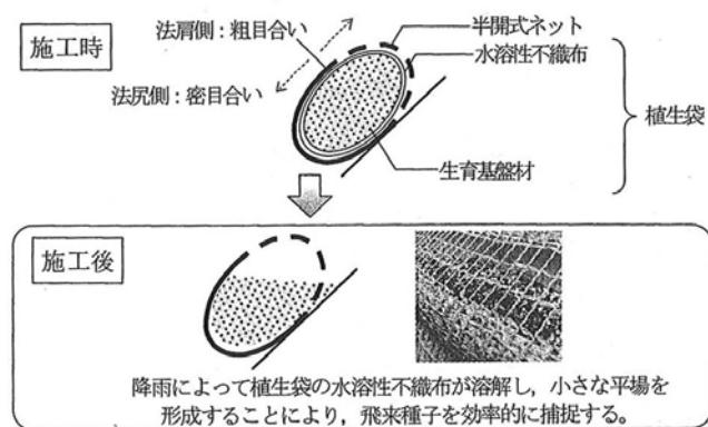
図-1 ネットの半開式構造
